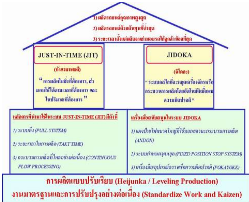
ภาพที่ 4.1 : ภาพแสดงหลักการและองค์ประกอบของระบบการผลิตแบบโตโยต้า
