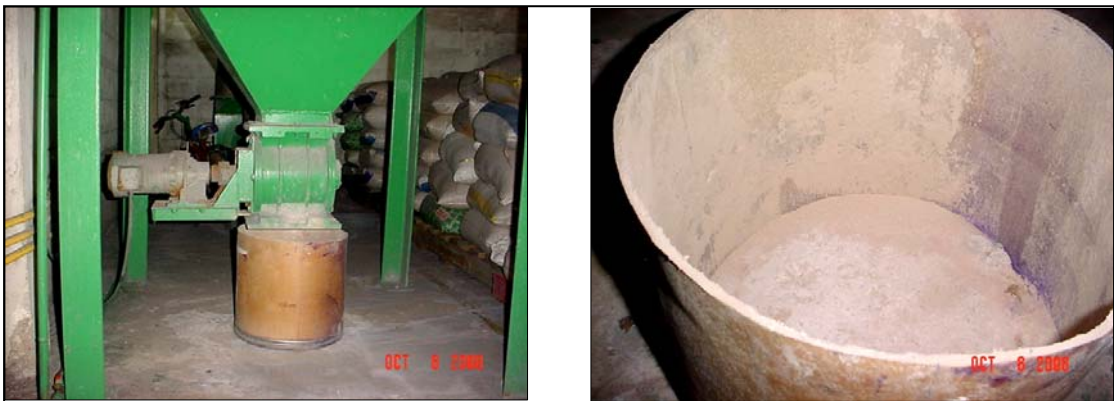
ภาพที่ 4.14 ตัวอย่างแสดงการเก็บเศษผงผลิตภัณฑ์จากเครื่องดักฝุ่นในถัง เพื่อรอการนำกลับไปใช้ใหม่
