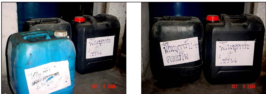
ภาพที่ 4.12 ตัวอย่างแสดงการเก็บตัวทำลายที่ใช้แล้วในถังเพื่อรอการนำกลับไปใช้ใหม่
