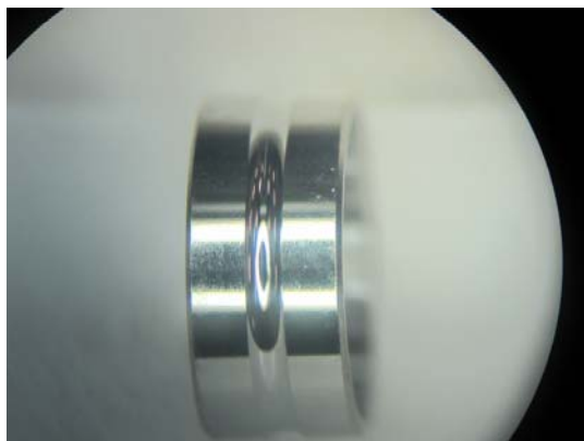
ภาพที่ 4.59 ชิ้นงานเสียในกระบวนการเนื่องจากปัญหา Dimension ใหญ่กว่า Spec.
