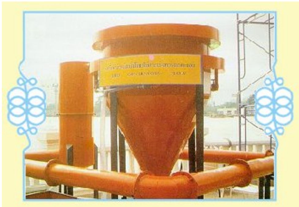
ภาพเครื่อง TRX-1 เป็นเครื่องบำบัดน้ำเสียด้วยสารเร่งตกตะกอน
