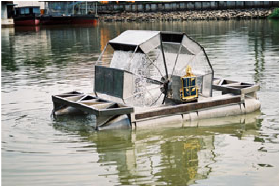
ภาพกังหันชัยพัฒนา เครื่องกลเติมอากาศที่ผิวน้ำหมุนช้าแบบทุ่นลอย ที่มา : มูลนิธิชัยพัฒนา, ม.ป.ป.
