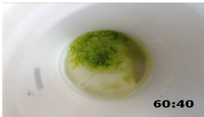
ภาพที่ 3.7 ชุดการทดลอง 5: ใช้น้ำเสียบ: น้ำประปาเท่ากับ 60:40
