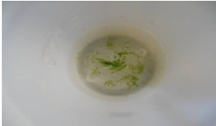
ภาพที่ 3.3 ชุดการทดลอง 1: ใช้น้ำเสีย: น้ำประปาเท่ากับ 0:100
