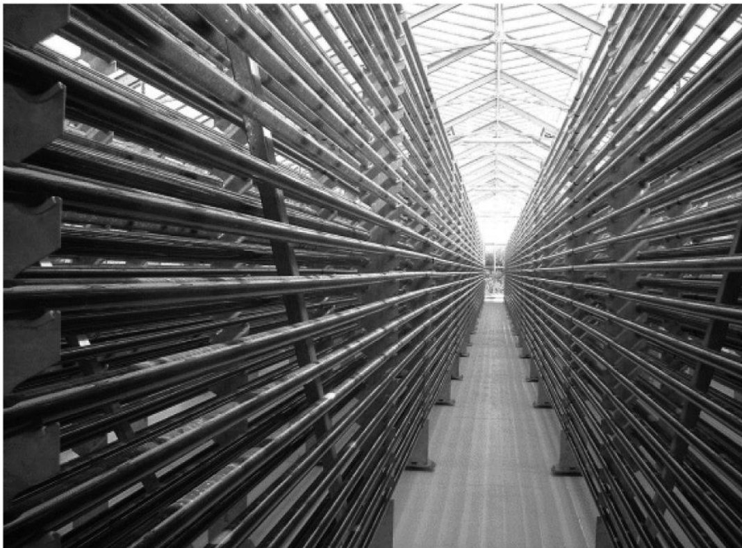
ภาพที่ 2.3 ถังปฏิกรณ์ชีวภาพชนิดท่อแบบให้แสง ที่มา: แพรพิลาศ ดุจจานุทัศน์, 2553
